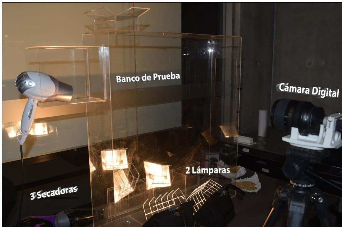
Figura 2.35 Configuración experimental PIV. Fuente: Elaboración propia.
