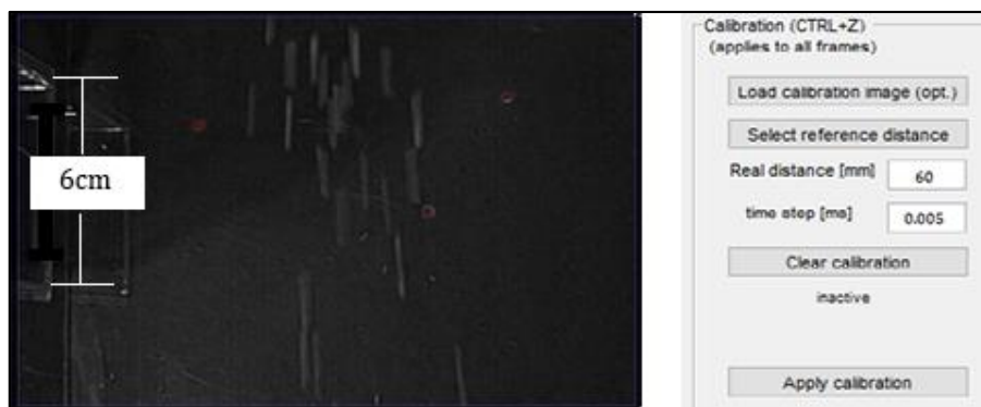
Figura 2.38 Calibración para obtener la velocidad de los vectores en PIVlab Fuente: Elaboración propia utilizando la aplicación PIVlab del software Matlab.
