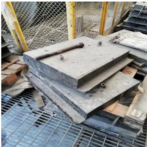
Figura 2.6 Liner del cuerpo del Molino sin grado de desgaste. Fuente: Buenaventura. Unidad Minera Uchucchacua [62]
