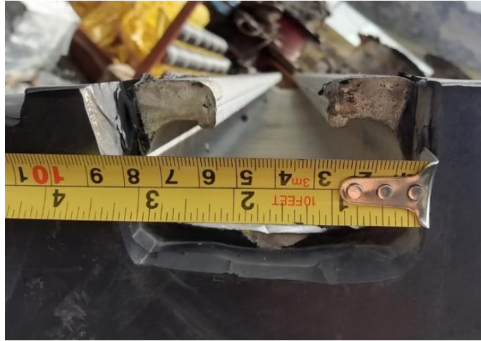
Figura 2.9 Ranura donde se instaló el sistema de control y monitoreo Fuente: Buenaventura. Unidad Minera Uchucchacua [62]
