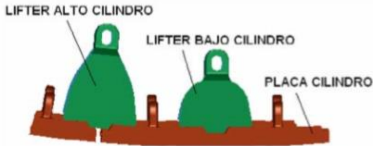
Figura 1.16 Revestimientos pertenecientes al cuerpo de un molino
