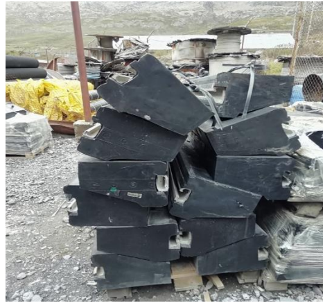
Figura 2.7 Lifter del Cuerpo del Molino sin grado de desgaste. Fuente: Buenaventura. Unidad Minera Uchucchacua [62]
