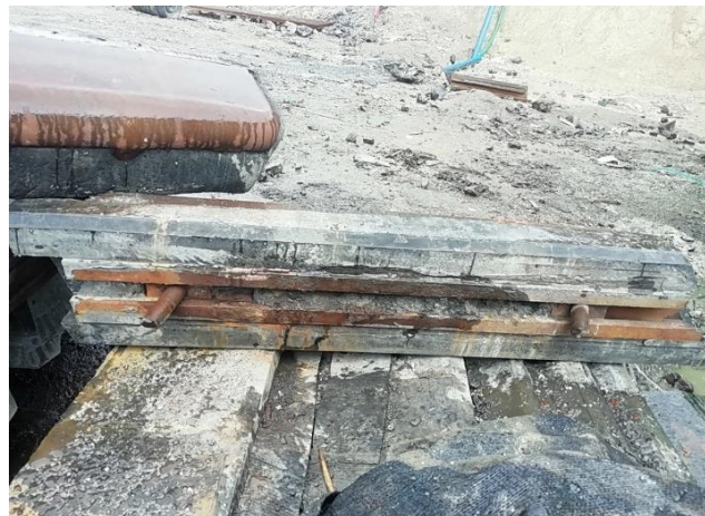
Figura 2.8 Lifters del Cuerpo del Molino desgastados Fuente: Buenaventura. Unidad Minera Uchucchacua [62]
