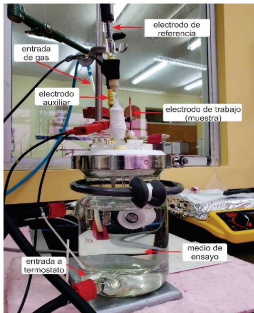
Figura 2.12 Esquema de celda electroquímica montada Fuente: Elaboración propia
