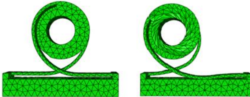
Figura 3.5. Mecanismo flexible deformado con un momento aplicado. Mecanismo flexible previo a la deformación (izquierda) y mecanismo deformado (derecha). La barra rectangular se traslada hacia la derecha al aplicar el momento antihorario.
