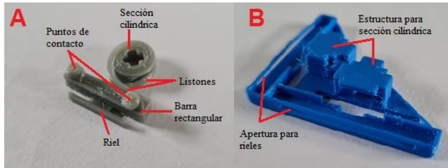
Figura 3.15. Prototipado de las partes del dispositivo háptico. El prototipo del mecanismo flexible (A) fue impreso en FilaFlex, mientras que el prototipo del soporte (B) en PLA.
