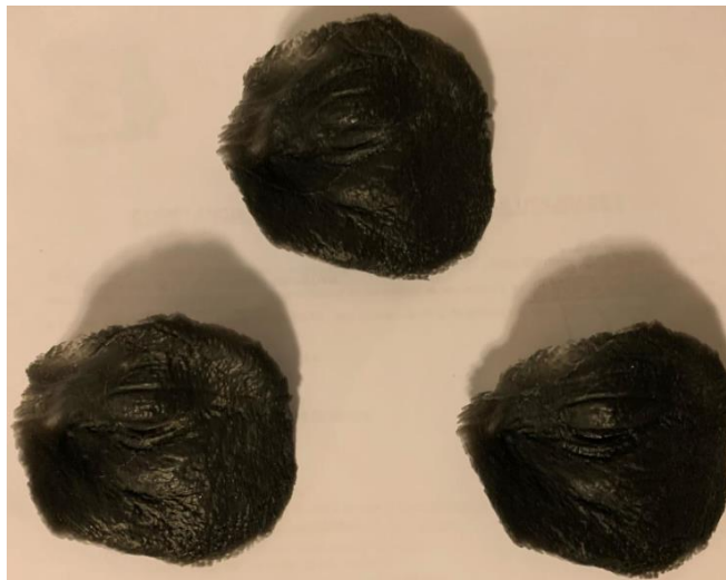
Figura 3.25: Modelos óculo-palpebrales impresos en el equipo Objet500 Connex3
