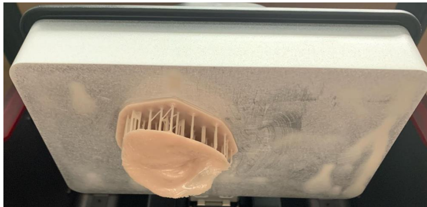
Figura 3.21: Modelo óculo-palpebral impreso equipo PRO95
