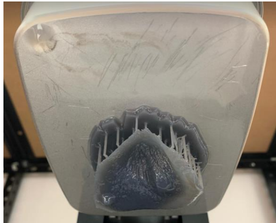
Figura 3.17: Modelo óculo-palpebral impreso en el equipo MoonRay S
