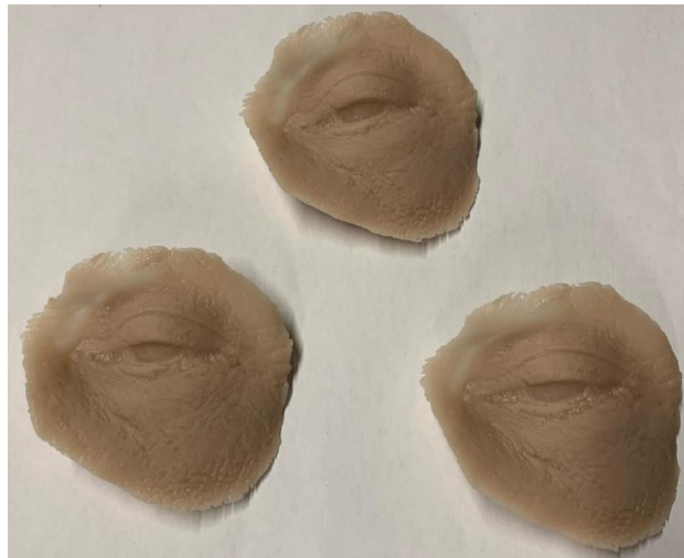
Figura 3.23: Modelos óculo-palpebrales impresos en el equipo PRO95
