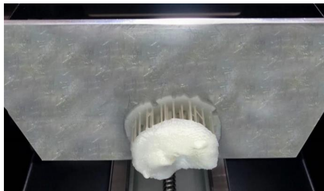
Figura 3.13: Modelo óculo-palpebral impreso en el equipo Phrozen Shuffle XL
