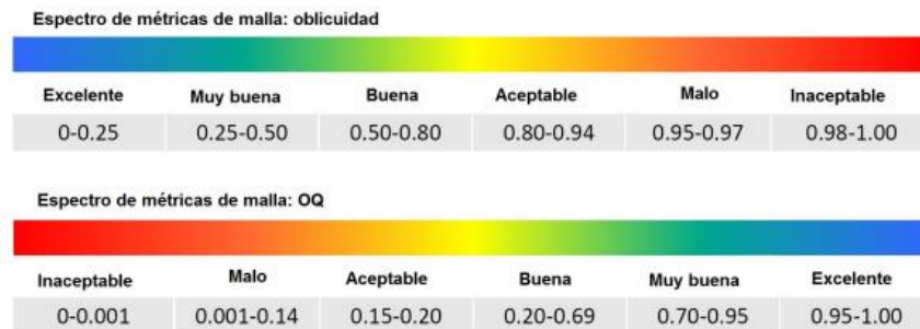
Figura 2.16 Calidad de mallada oblicuidad y octogonal.
