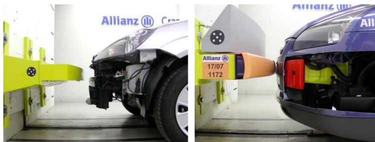
Figura 2.12 Parachoque desalineado y alineado. [43]
