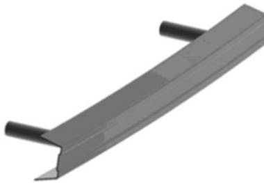
Figura 2.38 Generación del modelo CAD y FE del parachoques. [13]
