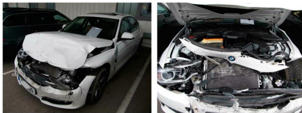
Figura 2.11 Daños innecesarios por parachoque bajo. [43]
