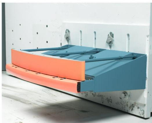
Figura 2.9 Barrera de impacto de la prueba IIHS. [41]
