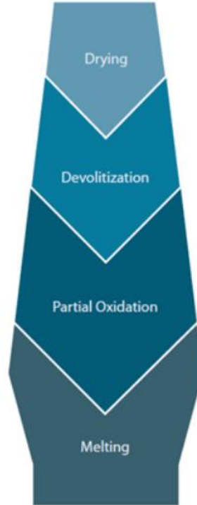
Figura 2.6 Esquema de un gasificador FastOx (Sierra Energy)
