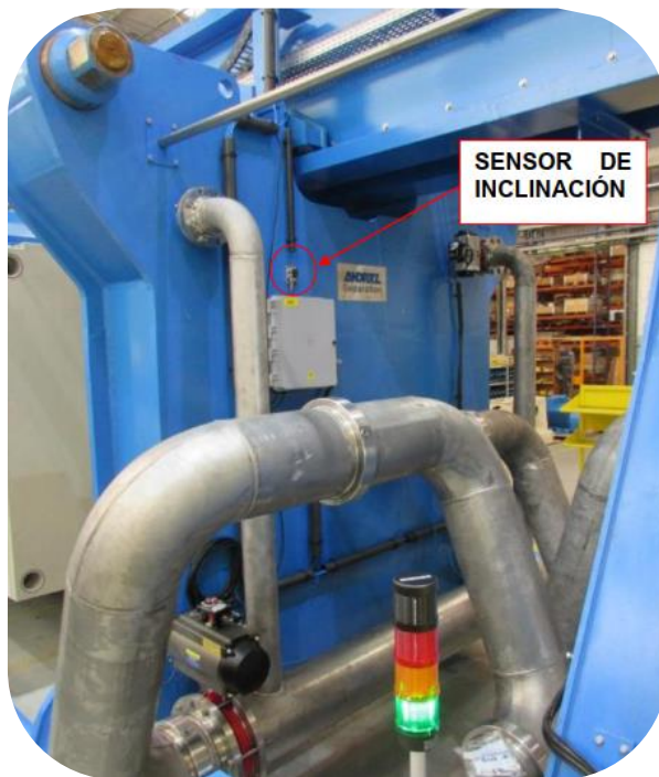
Figura 3.11 Sensor de inclinación de la placa móvil
