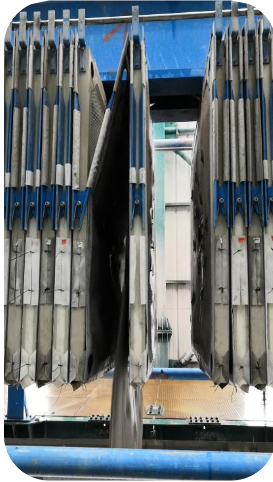
Figura 3.5 Placa de filtrado en desplazamiento, nótese la caída de torta de relave Fuente: Cesar Miranda. Visita a planta de procesamiento de mineral [31]
