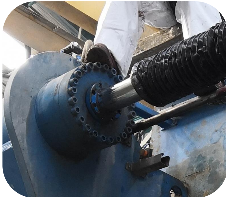
Figura 3.17 Evidencia de fuga de aceite en uno de los cilindros hidráulicos Fuente: Cesar Miranda. Visita a planta de procesamiento de mineral [31]
