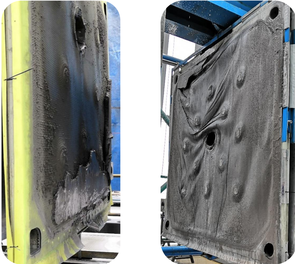
Figura 3.14 Evidencia de pegado de relave y desprendimiento de lonas de filtrado Fuente: Cesar Miranda. Visita a planta de procesamiento de mineral [31]
