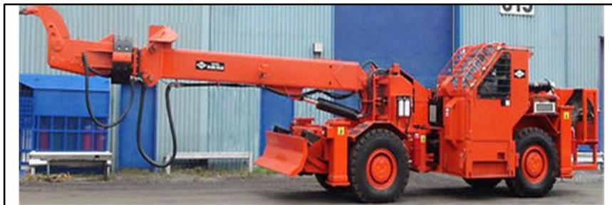
Fig 7.7 Máquina de purgado mecánico de túneles para mina.
