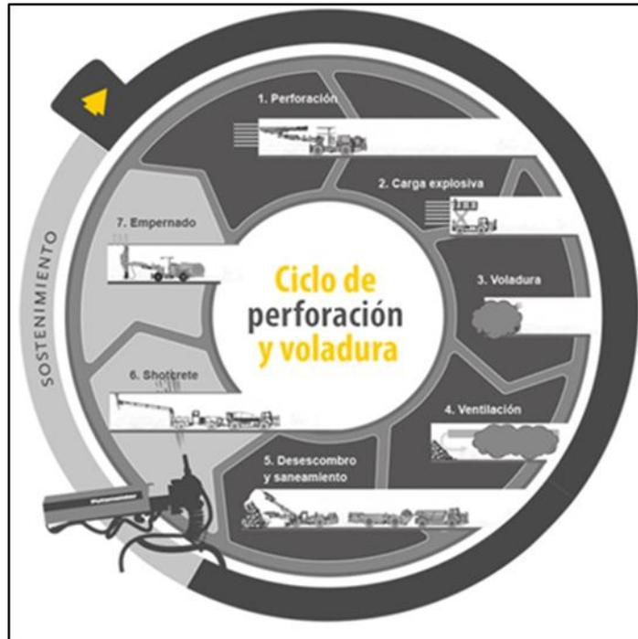
Fig 7.5 Ciclo de operaciones para realizar túneles en minería subterránea.
