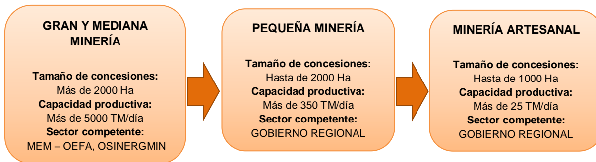
Figura 4. Estratificación de la Minería. Fuente: Sociedad Peruana de Derecho Ambiental (SPDA) [24]. Elaboración propia
