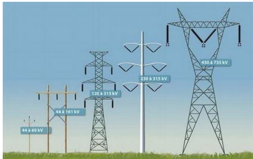
Figura 1.3 Estructuras para transmitir energía eléctrica de acuerdo al nivel de voltaje Fuente: Ricardo Arias. Capítulo de Potencia y Energía, Perú - IEEE-PES [24].
